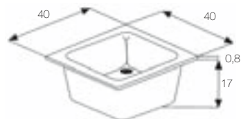
Lavello cucina da incasso quadro 40x40 cm Foro per incasso 38,5x38,5 cm Foro per piletta standard
